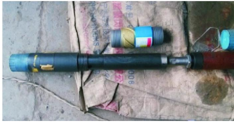
图 5 059 mm TT 型普通双管取心钻具
