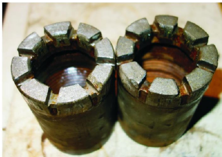
图 6 用过的孕镶金刚石钻头
