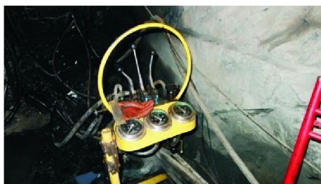
图3 Z7559型全液压钻机操纵台
