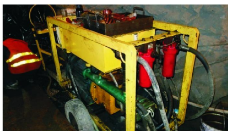
图2 Z7559型全液压钻机机动车
