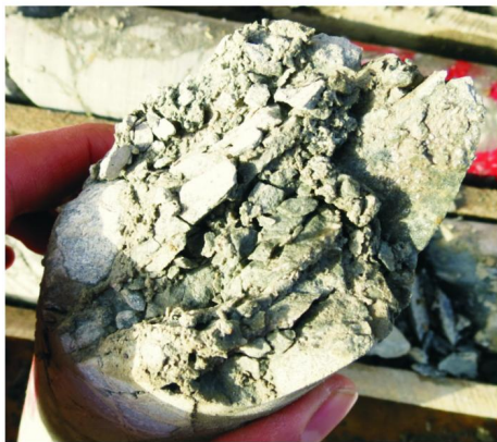
图 3 施工中取出的破碎地层岩心
