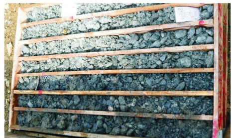
图 5 相邻赵沟矿区取出的构造角砾岩岩心
