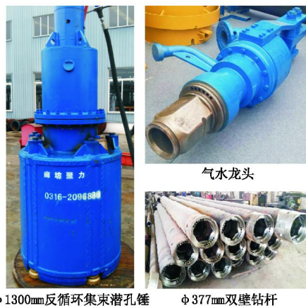
图7 \varnothing 1300\text{ mm} 反循环集束式潜孔锤、气水龙头、 \varnothing 377\text{ mm} 双壁钻杆
