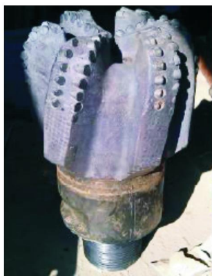
(a)用于登四段的 \phi 301 mm FX65D钻头
