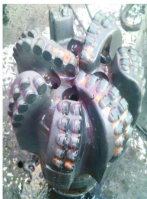
(b)用于沙河子组的 \phi 215.9 mm MM64DH钻头
