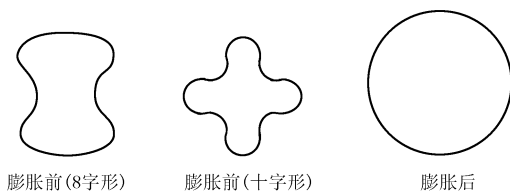
图 1 可膨胀波纹管原理图
