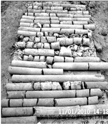
图7 华南国际金融中心基坑支护 \varnothing 1000@750 大直径(旋喷)搅拌桩桩身抽芯成果
