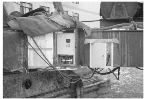
图4 变频器在长螺旋钻机上的连接
