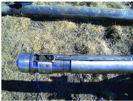
图 4 绳索打捞保压取心钻具内管总成齿轮齿条关闭球阀机构
