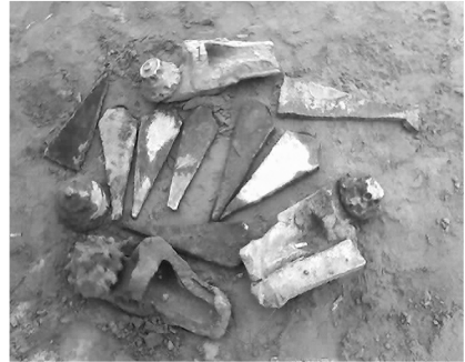
图4 钻孔内打捞出的部分残留物
