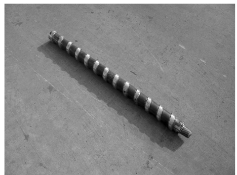
图 1 \varnothing 73/\varnothing 63.5 \text{ mm} 宽翼片螺旋钻杆
