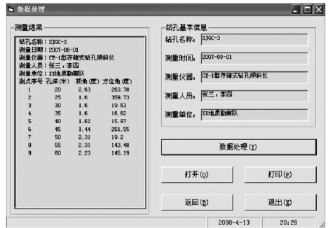
图 5 CE-1 型测斜仪软件数据处理结果
