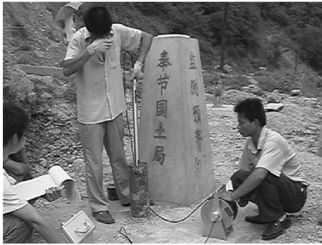
图 4 常规型测斜仪在滑坡监测中的应用
