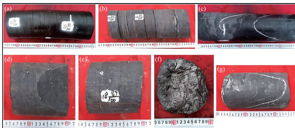
(a)未充填水平层理缝;(b)黄铁矿充填水平层理缝;(c)方解石充填斜交剪切缝;(d)未充填斜交剪切缝;(e)方解石充填垂直张裂缝;(f)未充填水平滑脱缝,具有镜面特征;(g)方解石充填斜交剪切缝和方解石充填水平层理缝所形成的裂缝网络
