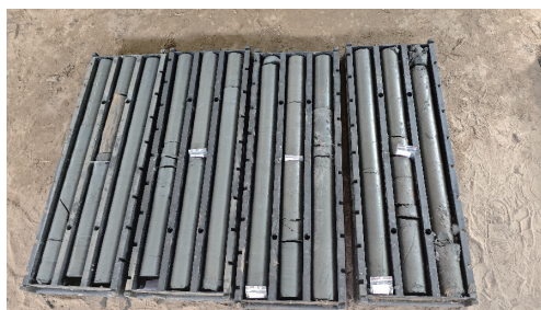
(b)微生物-CMC钻井液取心效果
