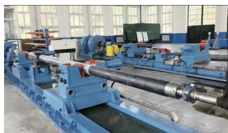
图13 涡轮钻具输出性能室内台架测试
