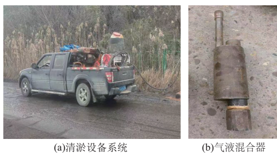
图4 反循环清淤设备集成系统实物
