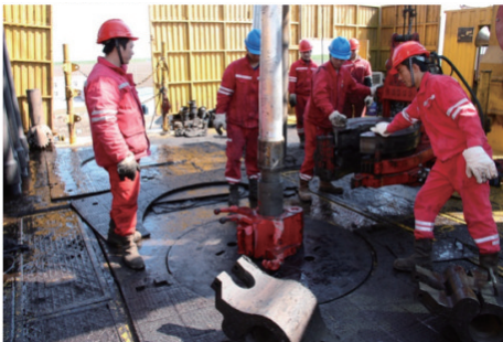
图 2 Ø147 mm 铝合金钻杆支撑服务“松科 2 井”
