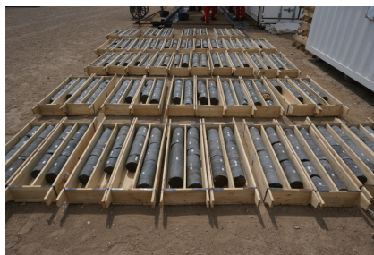
图5 KT-194型取心钻具获取的Ø124 mm岩心
