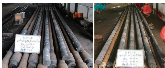
图3 井底动力驱动KT取心钻具及获得的岩心
