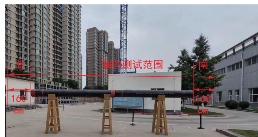
图5 轴向测试方案 Fig.5 Axial testing scheme
