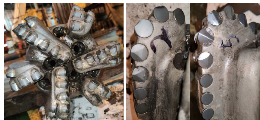
图7 HP636MDA磨损情况
