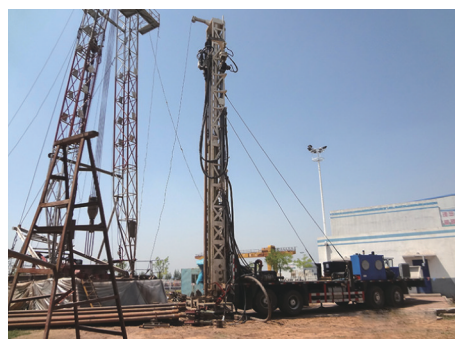
图4 SDC-1500型钻机集束式潜孔锤反井钻进
