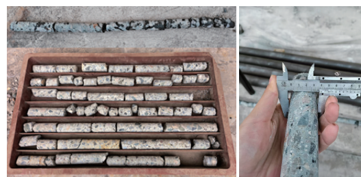
(a)钻取的部分岩心 (b)钻取的岩心直径40mm
