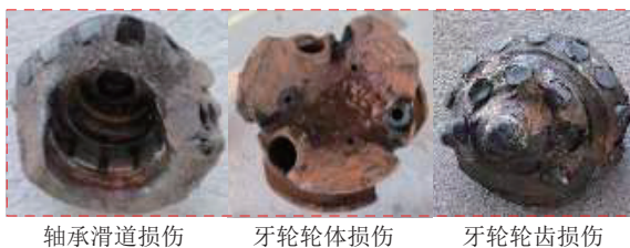
图9 钻进过程中钻头失效案例
