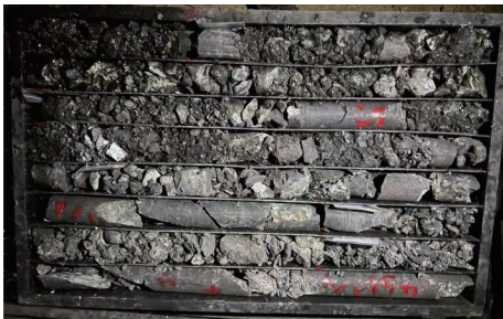
(a)破碎漏失段岩心
