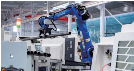
图 11 钻杆自动化生产线(来源:金石钻探(唐山)股份有限公司)
