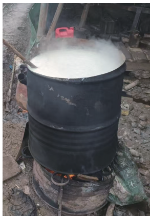
图 4 PVA 溶液加热溶解工艺
