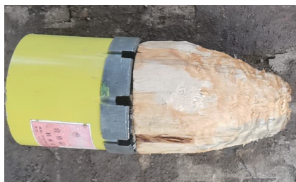
图1 木质导向头式 \varnothing 146 mm套管靴结构
