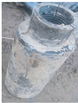
图2 公锥裂纹形貌
