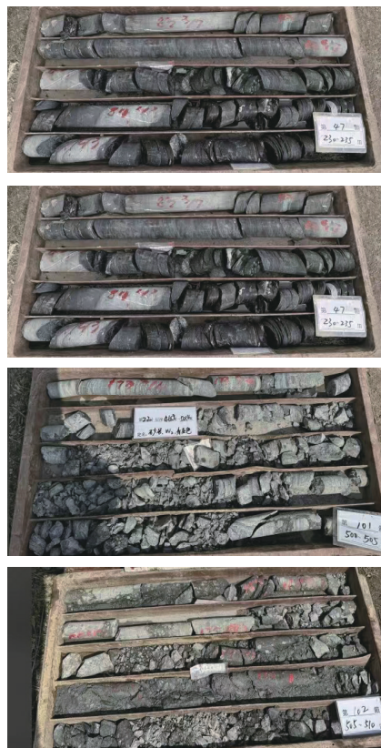
图3 破碎地层岩心样本
