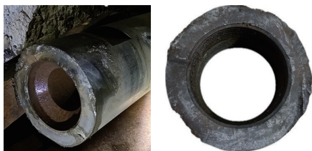
图1 钻杆接头断裂
