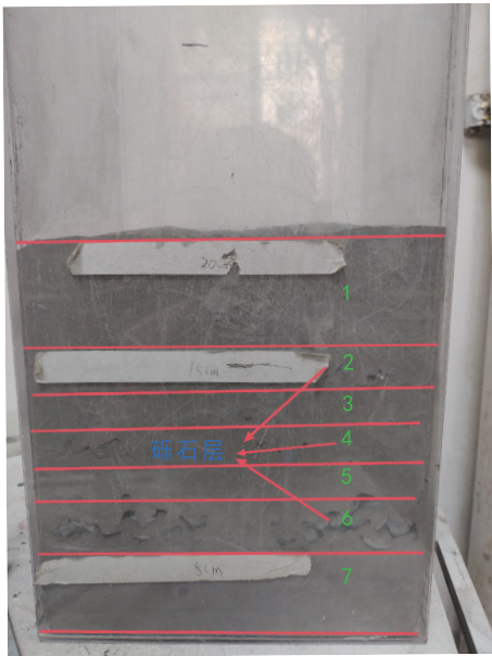
图 2 试验 5 含砾月壤层实物
