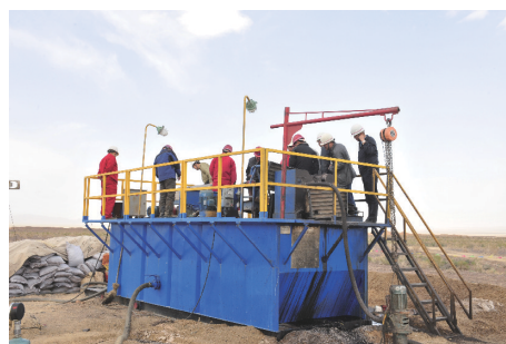
图4 GK-15冲洗液固控装置
