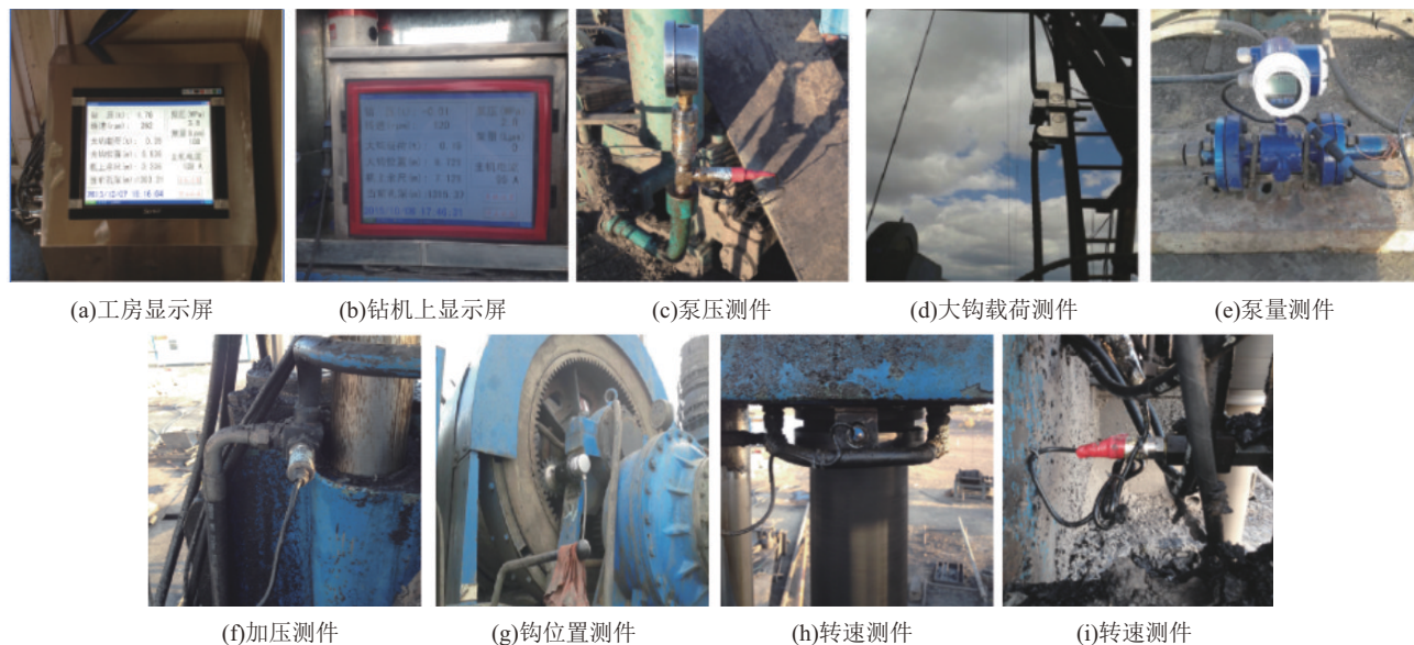
图5 钻进参数随钻监测系统主要部件
