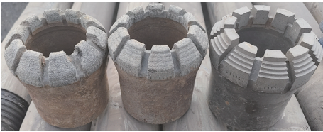
图1 阶梯式金刚石取心钻头
