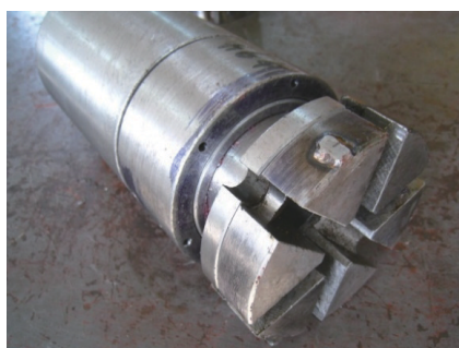
图13 环喷式反循环结构装配体
