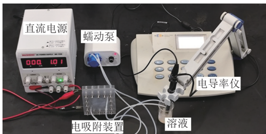
图6 全套装置实物
