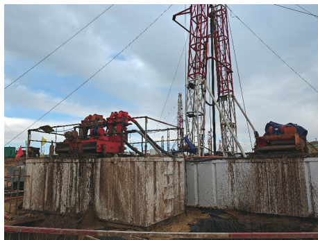
图7 除砂器+单联振动筛泥浆固控系统示意
