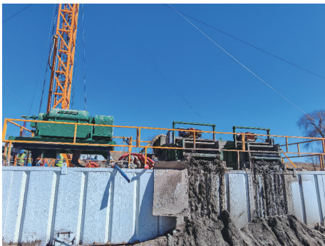
图 8 双联振动筛+离心机泥浆固控系统
