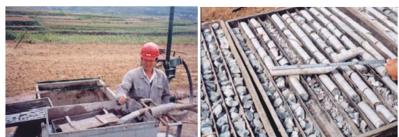
图2 水力RC钻探技术在固体矿产勘探进行钻探取心(样)施工场景
