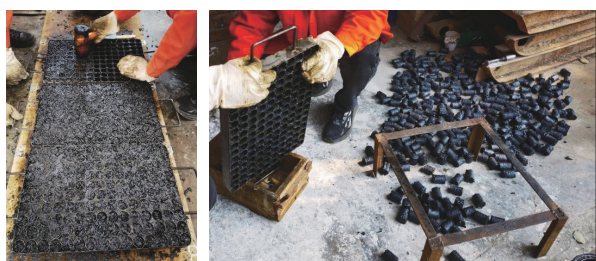
图2 混合料被网格刀切割成等体积圆柱体
