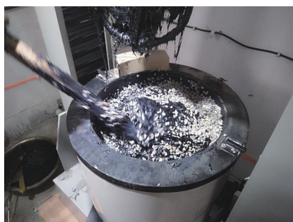
图1 堵漏小球混合料制备
