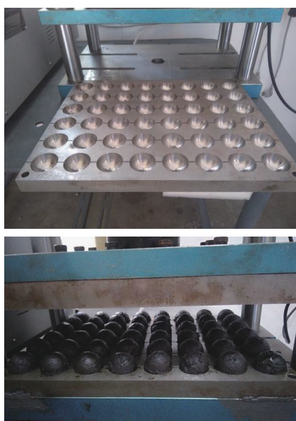
图3 成型模具冲压圆柱体成球
