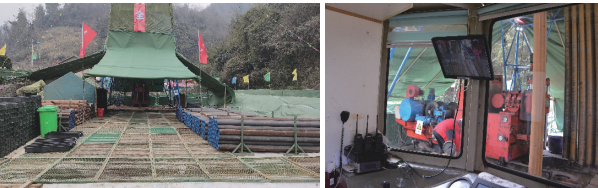
图7 电驱动钻机在水文孔ZK405应用
