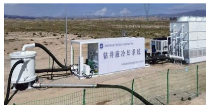
图9 钻井液冷却装置
