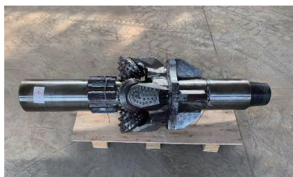
图4 \Phi 300 mm 大口径岩石层回拖扩孔牙轮钻头
