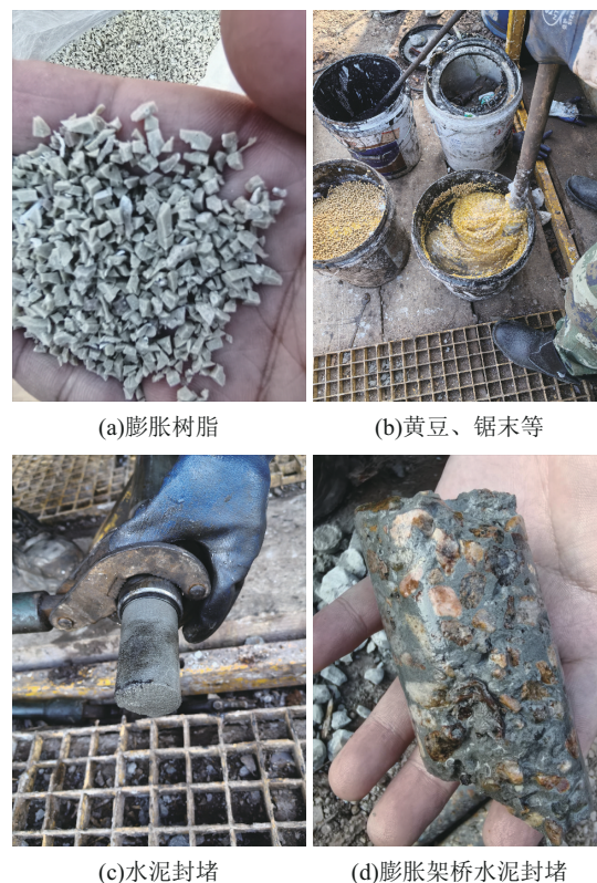
图7 堵堵材料及效果
