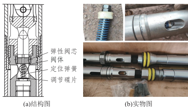
图6 定压开启阀装置
