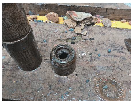
图4 漏失段的钻头磨损情况
