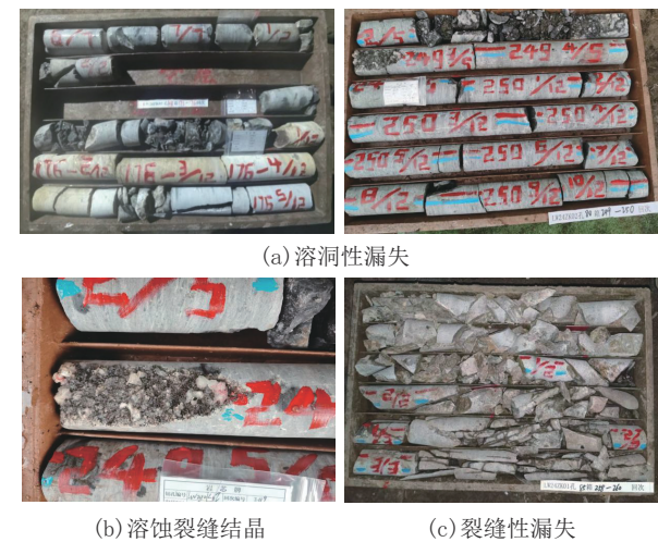
图 2 钻遇的漏失地层照片
