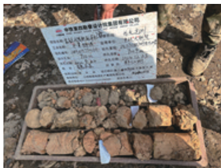
(b) 采用活动分水钻具采样方式的岩心
