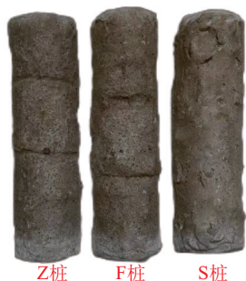
图 6 不同粗糙度的桩模型 Fig.6 Pile models with different roughness levels
