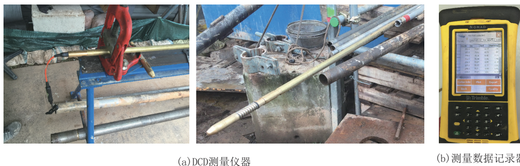
图6 DCD取心工艺钻孔轨迹测量仪器
