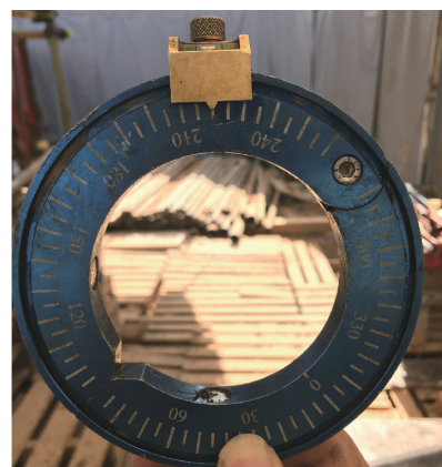
(b) 工具面方位角定位圆尺
