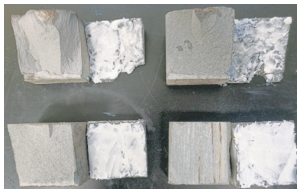
图6 E-51环氧树脂、SA-Mic对水泥石自然断裂面、切割面的胶黏性能
