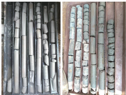
图3 空中架桥取出的水泥柱情况
