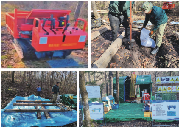
图3 模块化钻机搬运与搭建
