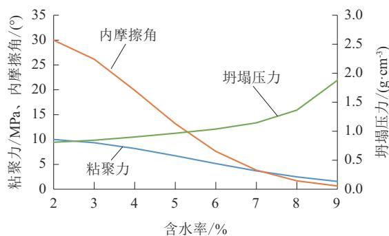
图3 粘聚力、内摩擦角及坍塌压力(当量密度)与含水率关系
