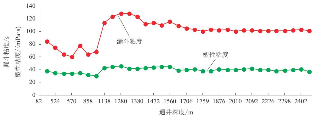
图6 钻井液塑性粘度与通井深度关系
