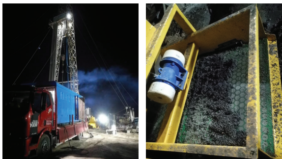
图13 气举反循环现场取样
