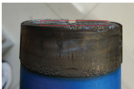
图7 热-机碎岩钻头钻进试验后摩擦元件高度位置
