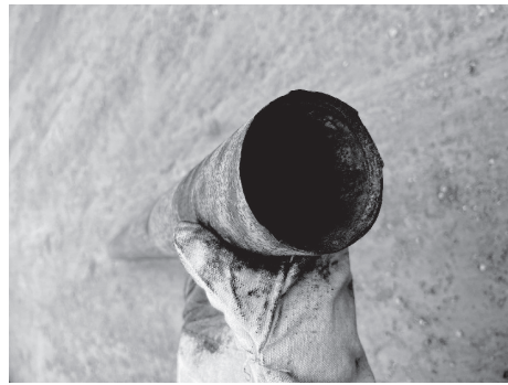
图4 钻具切割后截面
