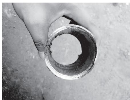
图3 试切割钻杆截面
