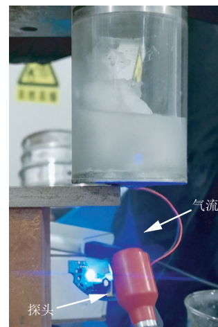
图 4 甲烷水合物雾化排水产气实验
