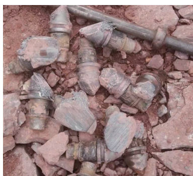
图2 旋挖钻头磨损情况
